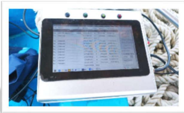
Automatic Identification System (AIS) merupakan sebuah alat navigasi yang wajib dipasang di Kapal ukuran 35 GT dan Kapal Penangkap Ikan 60 GT sesuai dengan Peraturan Menteri Perhubungan No. 7 Tahun 2019. AIS merupakan pengembangan
